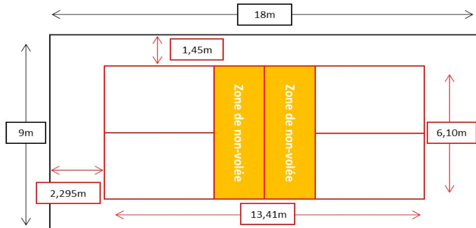
Les dimensions d'un terrain de pickleball sont un rectangle de 6,10 mètres de large et de 13,41 mètres de long, pour les matchs en simple comme pour les matchs en double (+/- 1 cm sur la largeur et +/- 0,5 cm sur la longueur).
