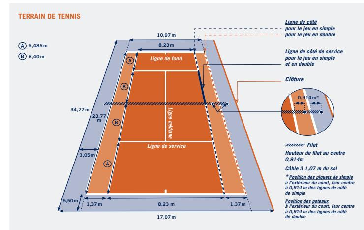
*Note : Afin d'éviter l'éblouissement des joueurs au soleil levant et au soleil couchant, il est recommandé de prévoir une orientation nord-sud suivant le grand axe du terrain.*
